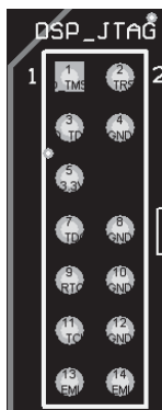
图表2-6 LINK板DSP_JTAG接口示意图
