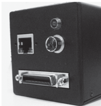
图表2-2 摄像头后面板外部接口图
