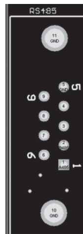
图表2-7 LINK板RS485接口示意图
